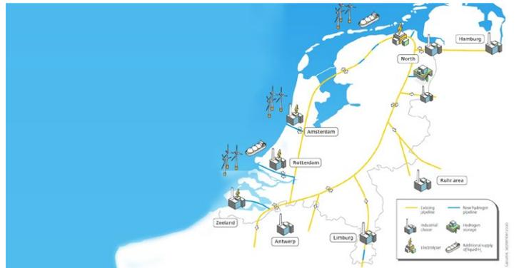
オランダでは、2030年までに、1,400kmのパイプラインで構成される国内水素バックボーンを構築できるよう開発が進められています。この供給網は地域のバックボーンと互いに連結するだけでなく、産業消費者や港湾施設といった大規模クラスターのほか、オランダ国外の備蓄施設やグリッドにも接続される予定です。このバックボーンの85%は使用済みのガスインフラで構成されるものと予想されています。
