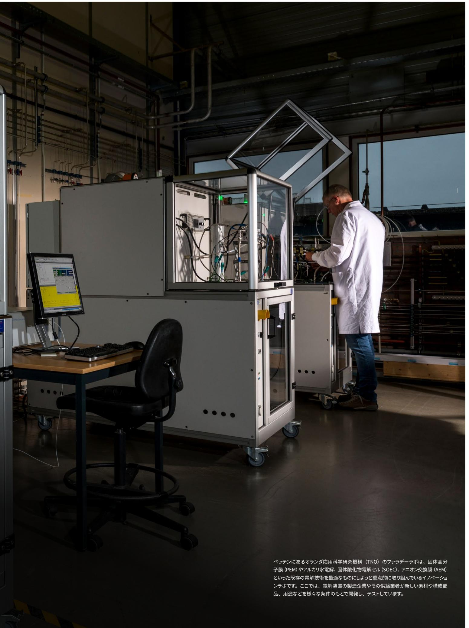
ペッテンにあるオランダ応用科学研究機構 (TNO) のファラデーラボは、固体高分子膜 (PEM) やアルカリ水電解、固体酸化物電解セル (SOEC)、アニオン交換膜 (AEM) といった既存の電解技術を最適なものにしようとする重点的に取り組んでいるイノベーションラボです。ここでは、電解装置の製造企業やその供給業者が新しい素材や構成部品、用途などを様々な条件のもとで開発し、テストしています。
